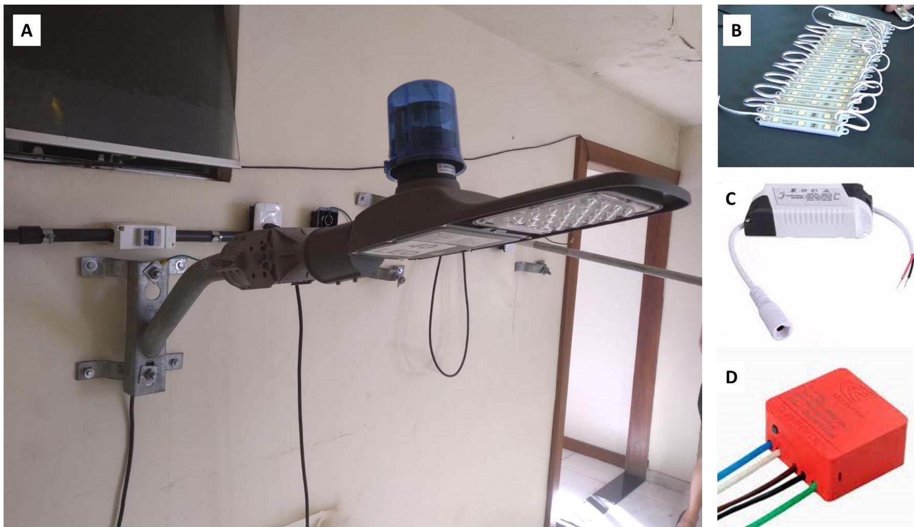
Figura 8 - A) Luminária LED B) Módulo LED C) Driver e D) Dispositivo de Proteção contra Surtos – DPS. Fonte: LUZ DE BELÉM, 2022
